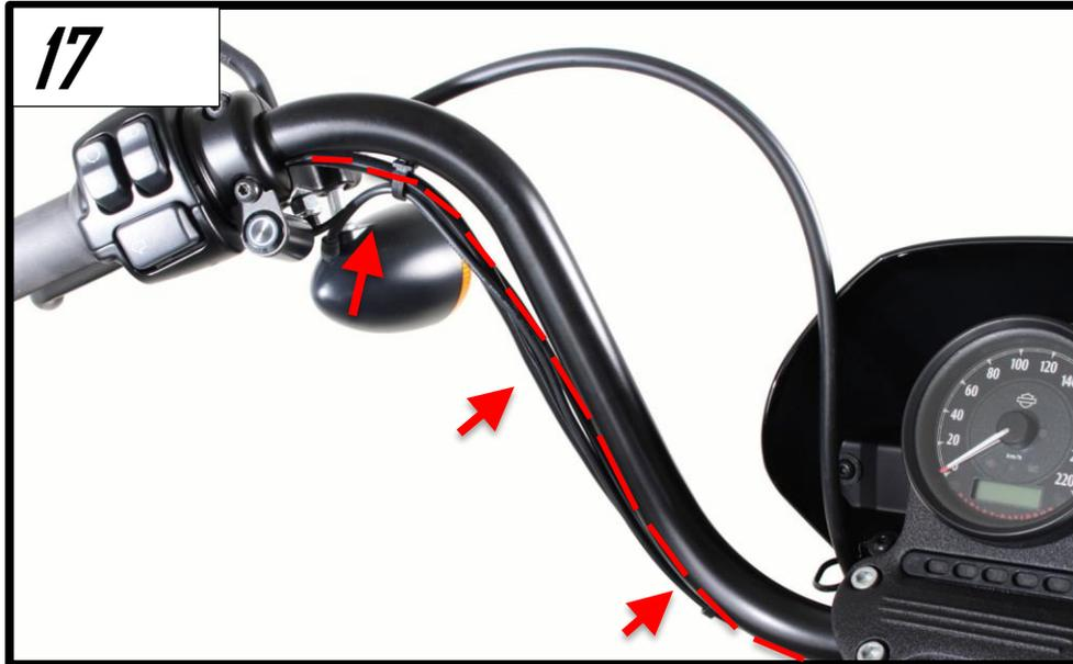
Verlegen Sie das Taster Kabel mit dem Serienkabelstrang bis zum REMUS Steuergerät und stecken sie dieses an das REMUS Steuergerät (Abb.18 / 19).
