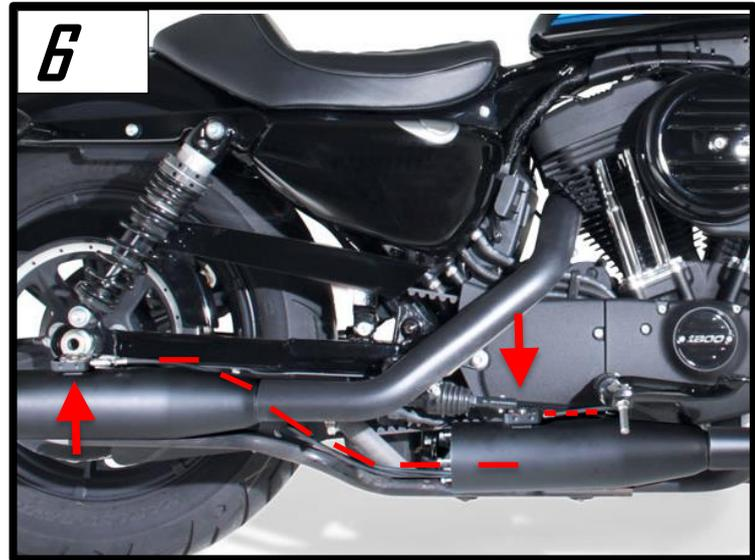
Hängen sie die Bowdenzüge in die farblich gekennzeichneten Öffnungen (rot – rot, blau – blau...) (Abb. 7 / 8)
